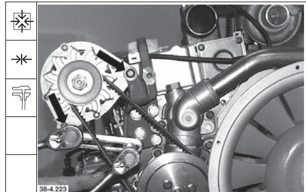
47. Keilriemenspannung mit Spannungsmeßgerät prüfen.
