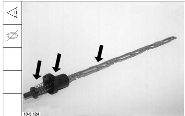
2. Führungsbuchse am Spannstift aufbohren und entfernen.
