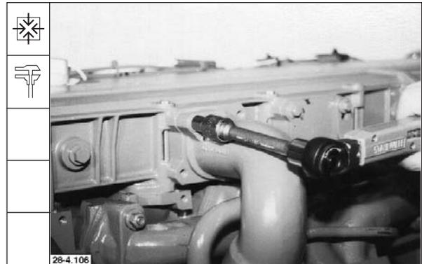
205. Falls vorhanden, Öleinfüllstutzen mit neuer Dichtung anbauen und mit einem Drehmoment von **21 ± 2 Nm** festdrehen.
