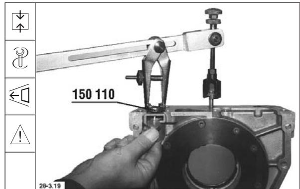
7. Wellendichtring mit Montagevorrichtung montieren.
