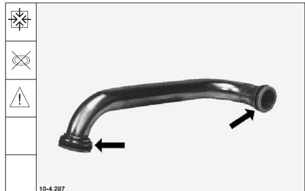
54. Kühlmittelrohr mit Flansch vormontieren.
