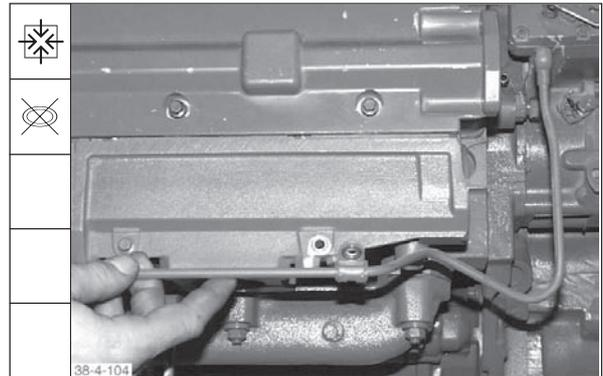
167. Schraube für Entlüftungsleitung mit einem Drehmoment von **11 ± 1 Nm** festziehen.
