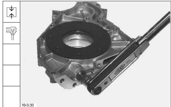
6.1 Druckregelventil BFM 1013 einbauen:
