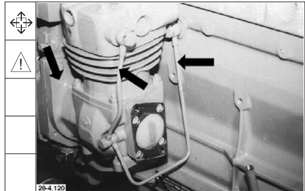
2. Neuen Runddichtring montieren.
