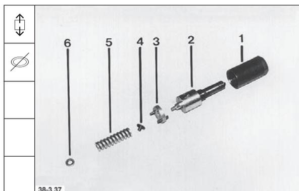
Sämtliche Teile in sauberem Dieselkraftstoff reinigen und mit Druckluft ausblasen.
