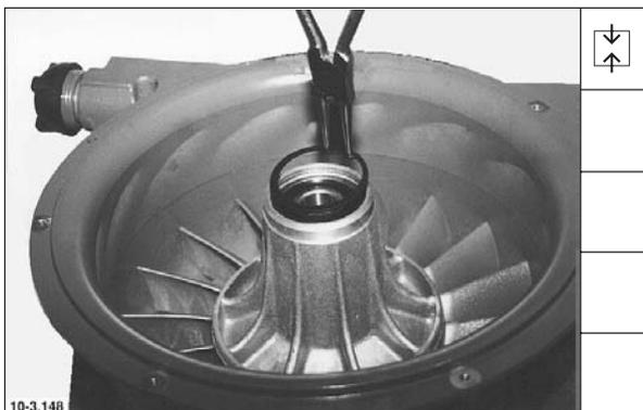
13. Sicherungsring montieren.
