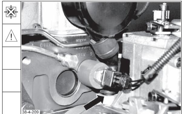
175. Schrauben mit einem Drehmoment von  $8,5 \pm 1 \text{ Nm}$  festdrehen.
