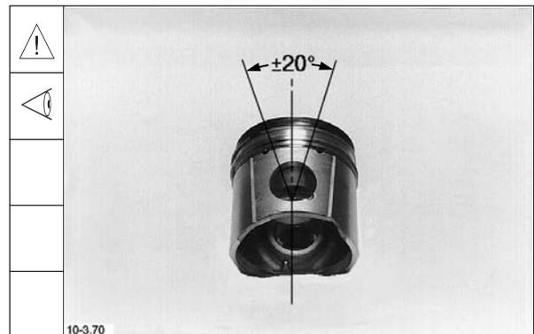
16. Kolben mit der Pleuelstange montieren.
