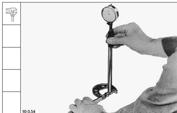
2. Kolbenbolzenbuchse an den Punkten "1" und "2" in der Ebene "a" und "b" messen.
