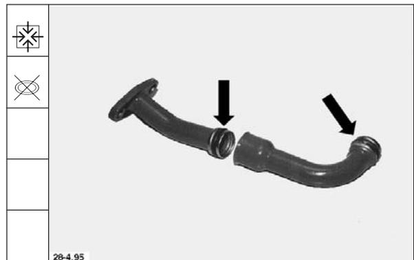
191. Rücklaufrohr mit neuer Dichtung an-bauen.
