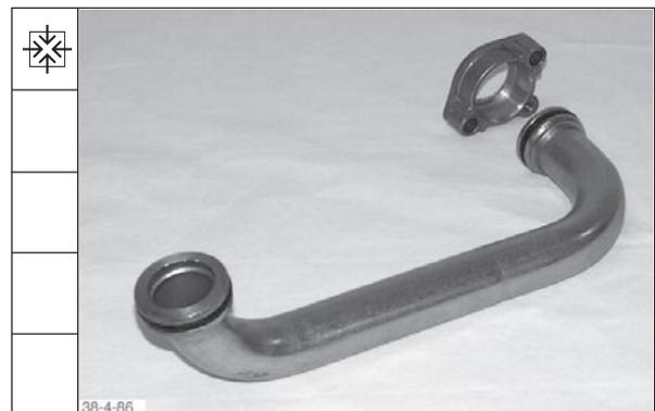
55. Dichtfläche des Flansches mit Dichtmasse **DEUTZ DW 67** bestreichen. Kühlmittelrohr anbauen.
