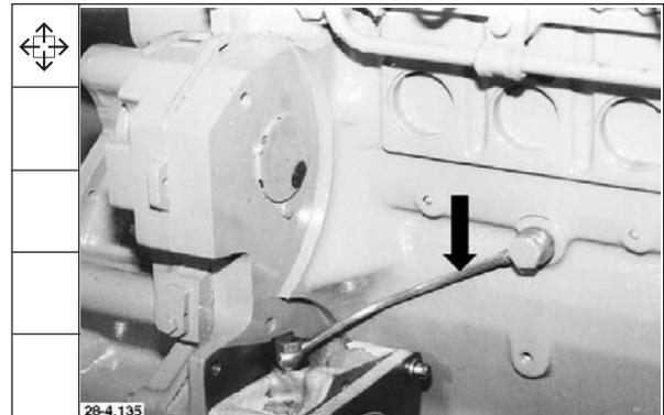
2. Hydraulikpumpe abbauen.
