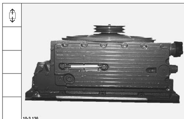
2. Sicherungsring für Druckventil herausnehmen. Druckventil ausbauen.
