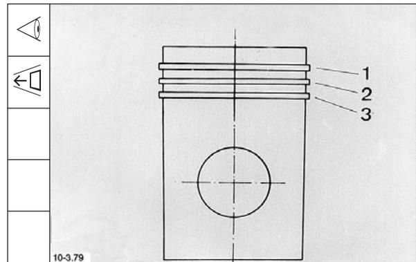
8. Kolbenringe montieren.
