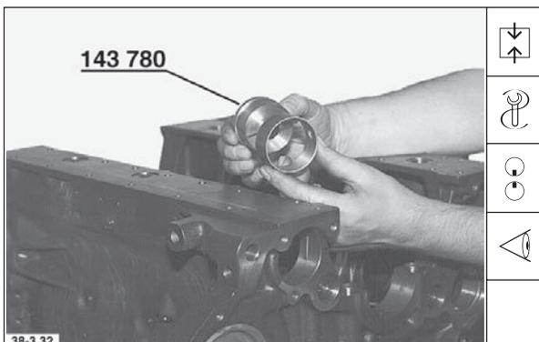
19. Neue Lagerbuchse ansetzen, markieren und auf Übereinstimmung der Schmierölbohrungen / Zentrierbohrungen achten.
