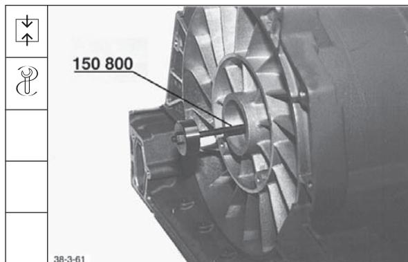
9. Kugellager (2 Stück) mit Distanzbuchse komplett aus Gebläseträger herausziehen.
