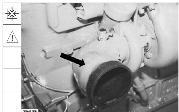
198. Entlüftungsleitung mit Halter spannungsfrei anbauen.
