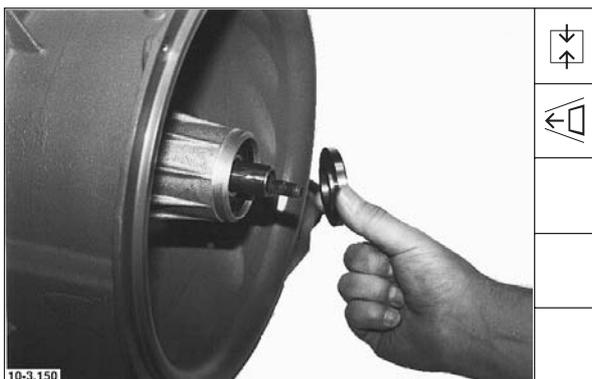
15. Druckstück aufsetzen.
