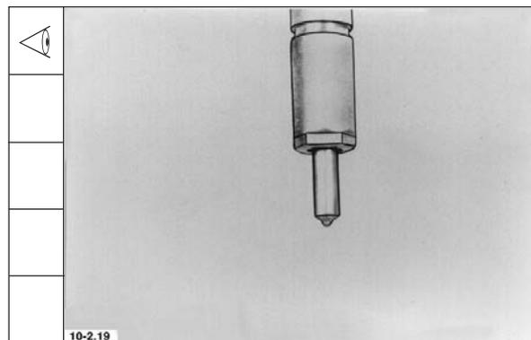
7. Fällt ein Tropfen ab, ist das Einspritzventil zu zerlegen und die Undichtigkeit durch Reinigen zu beseitigen. Ist das nicht erfolgreich, muß die Einspritzdüse erneuert werden.
