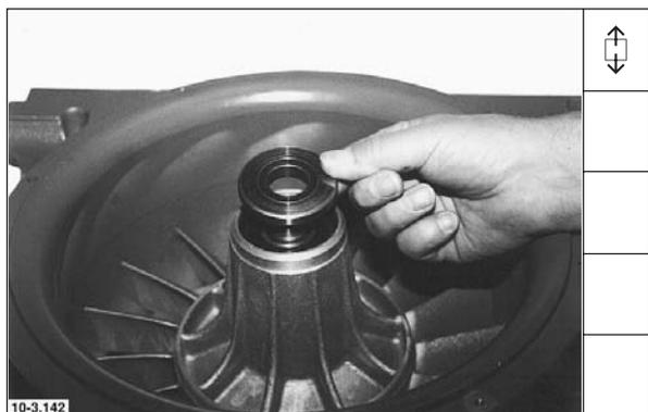
4. Druckventil einsetzen.
