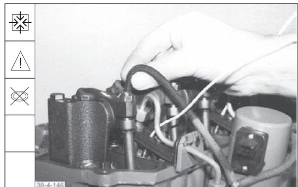
120. Überströmventil mit neuen Cu-Dichtungen und Leckölleitung anbauen. Überströmventil mit einem Drehmoment von **30 Nm** festdrehen.
