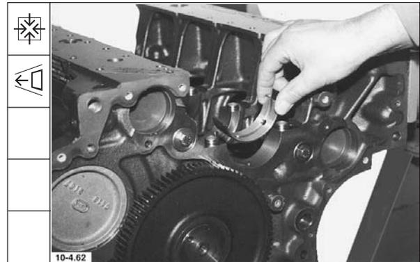
7. Lagerschalen in Hauptlagerdeckel einsetzen.
