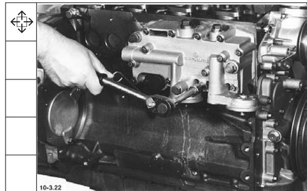
22. Kühlmittelpumpe mit Thermostatgehäuse abbauen.
