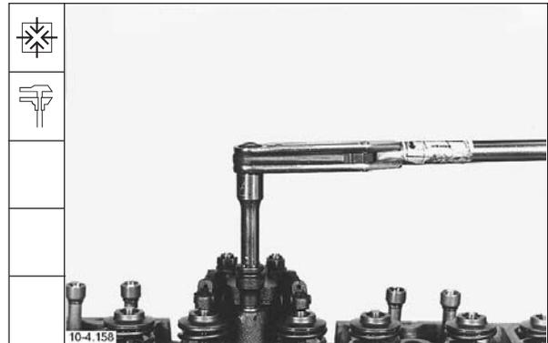
104. Zylinderkopfschrauben nach Anziehvorschrift festdrehen.
