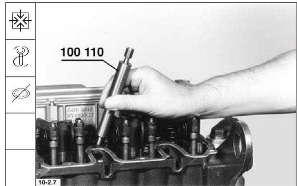
2. Spannpratze aufsetzen. Schraube festdrehen.
