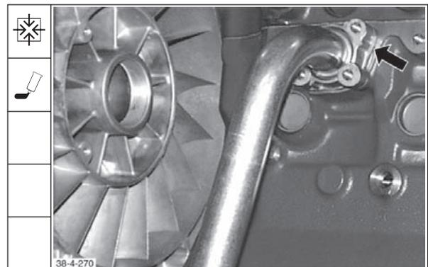
56. Schrauben mit einem Drehmoment von **28 Nm** festdrehen.
