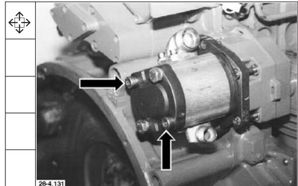
2. Schrauben von Führungsflansch heraus-schrauben.
