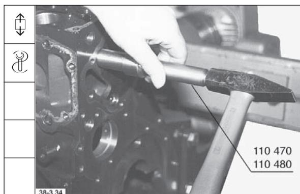
22. Führungsbuchse schwungradseitig austreiben, bei BF6M Motor.
