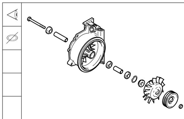
11. Kleines Kugellager über den Außenring bis Anlage eindrücken.
