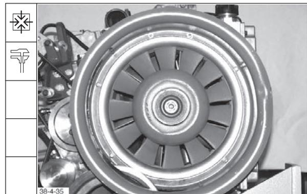
49. Spannrolle mit Konsole anbauen und mit einem Drehmoment von **29 Nm** festdrehen.
