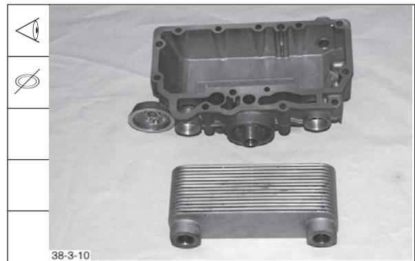
4. Ölkühler in Ölkühlergehäuse einsetzen.
