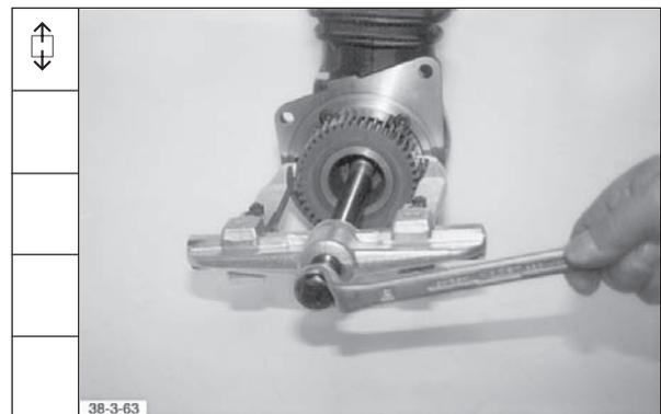
3. Zahnrad aufsetzen und Befestigungsmutter beidrehen.
