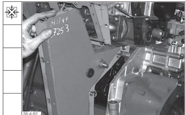
63. Kabel an Starter und Anschlußbolzen anbauen.
