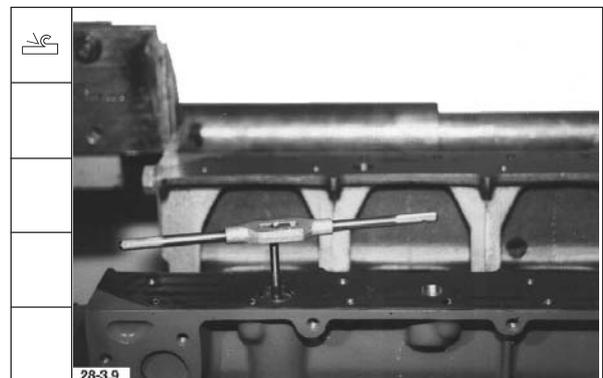
30. Ausziehvorrichtung einschrauben und Druckhalteventil herausziehen.
