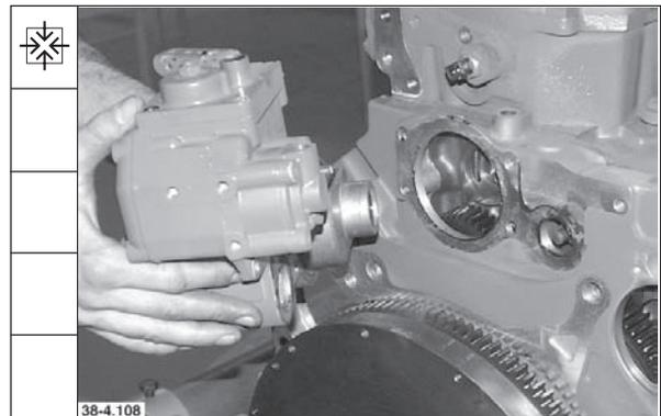
152. Schrauben in der Reihenfolge 1-2-3-4-5 mit einem Drehmoment von  $17 \pm 1,5$  Nm festdrehen.
