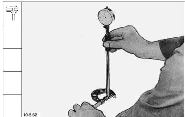
10. Schema zum Vermessen der Pleuellagerbohrung an den Punkten "1" und "2" der Ebene "a" und "b".
