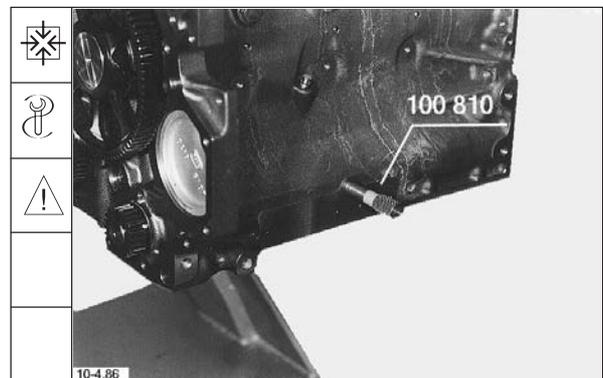
32. Anlaufscheibe anbauen und zur Wellenachse ausrichten.
