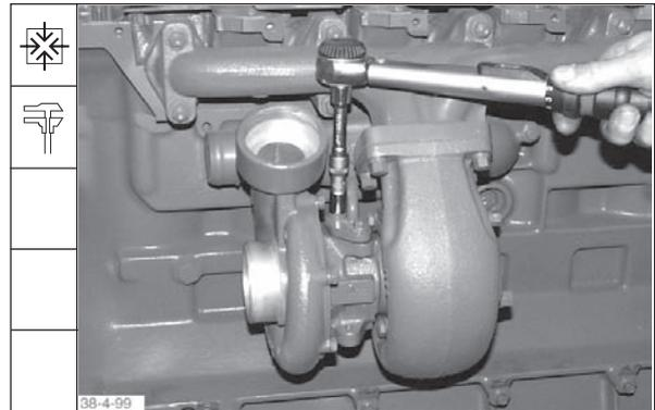
189. Hohl-schraube mit neuen Cu-Dichtringen anbauen und mit einem Drehmoment von **39 ± 3 Nm** festdrehen.
