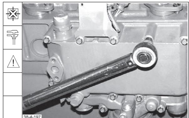
129. Beide Einschraubstutzen mit neuer Cu-Dichtung anbauen.
