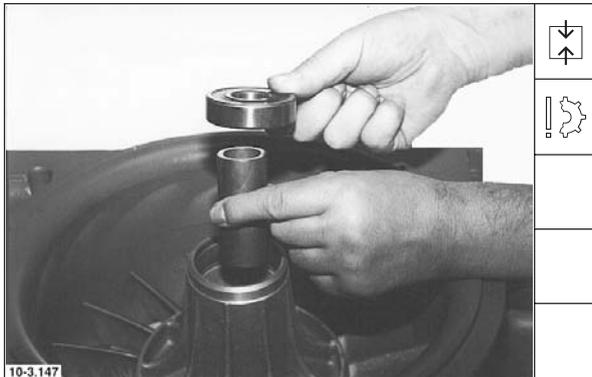
12. Distanzbuchse einsetzen. Großes Kugellager über den Außenring bis Anlage eindrücken.
