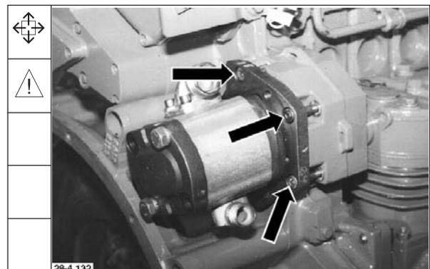
3. Vormontierte Hydraulikpumpe mit Führungsflansch anbauen.
