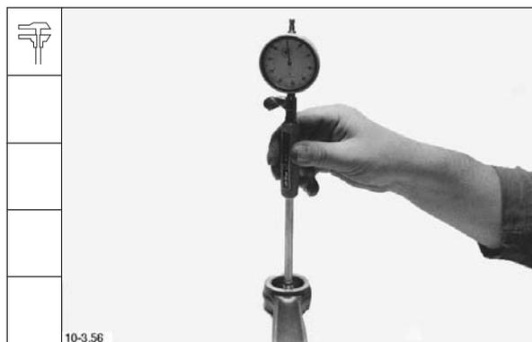
4. Bei Bedarf Kolbenbolzenbuchse auswechseln.
