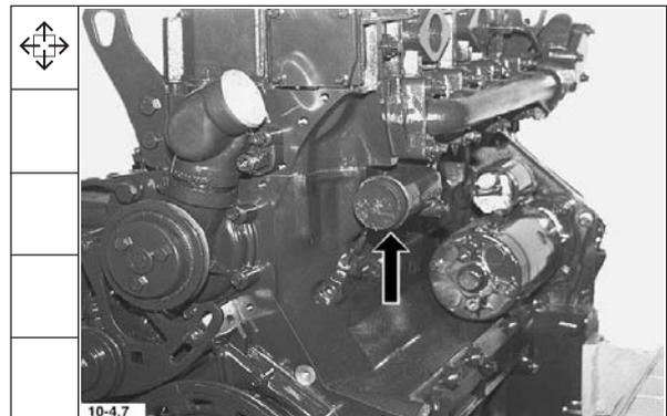
7. Entlüftungsleitung mit spez. Federklemmenzange abbauen.
