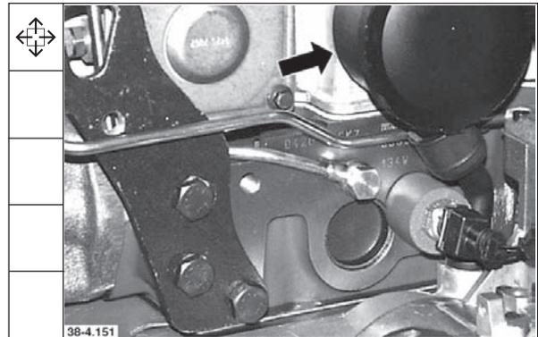
13. Luftleitung zum LDA und Entlüftungsleitung abbauen.
