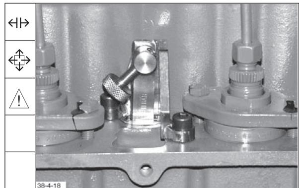
11. Regelstange mittels Abstellhebel in Stopstellung drücken. Abstellmagnet mit neuem Runddichtring einbauen.
