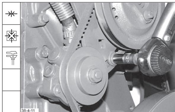
213. Keilriemenspannung mit einem Spannungsmeßgerät prüfen.
