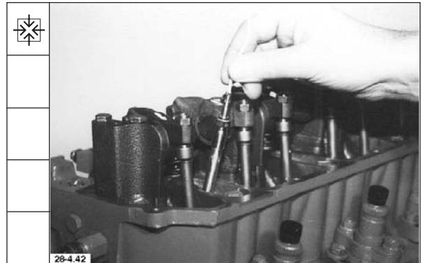
111. Glühstiftkerzen oder Verschlußteile mit einem Drehmoment von  $20 \pm 2$  Nm festdrehen.
