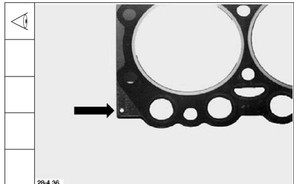
98. Zylinderkopfdichtung auflegen.
