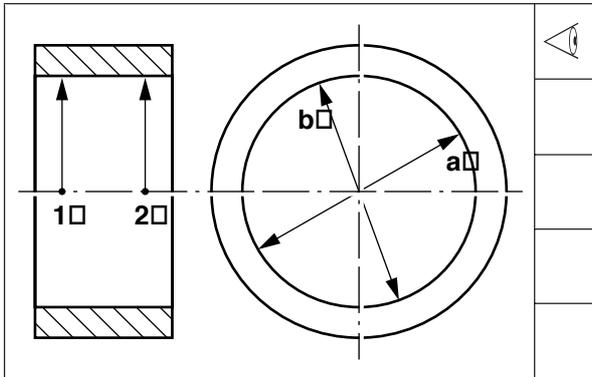
16. Schema zum Vermessen der Lagerbuchsen an den Punkten 1 und 2 in der Ebene "a" und "b".
