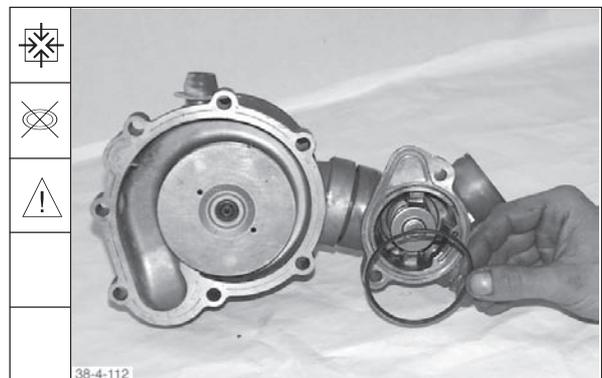
136. Vormontierte Kühlmittelpumpe mit neuer Dichtung anbauen.
