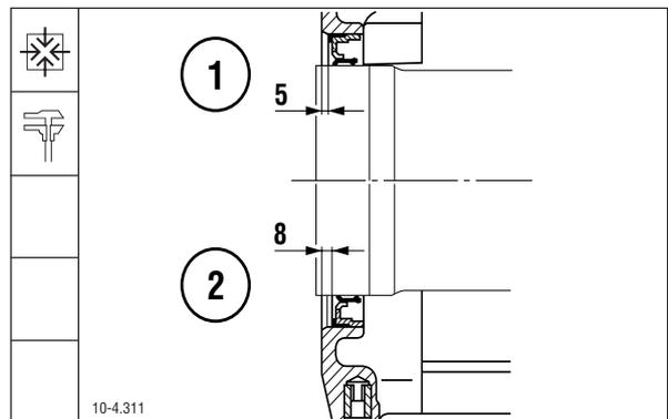
4.1 Dichtlippen einölen. Wellendichtring mit Eindrückvorrichtung montieren. Dichtlippe weist zur Kurbelwelle.
