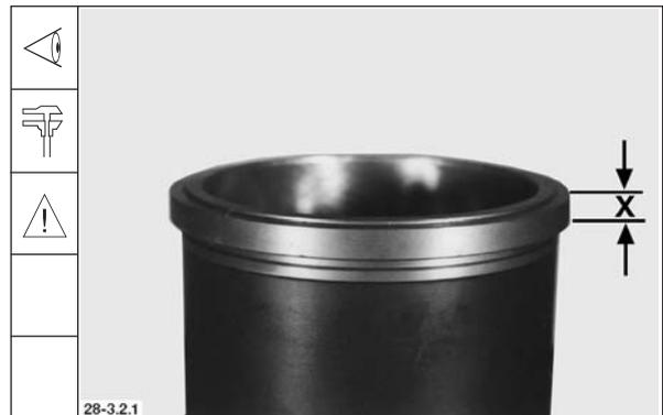
5. Bundauflage und Dichtfläche für Zylinderlaufbuchse sichtprüfen.
