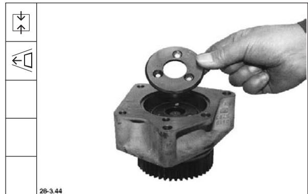
9. Schrauben mit einem Drehmoment von  $8,5 \pm 1$  Nm festdrehen.
