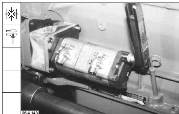
10. Öldruckleitung mit neuen Cu-Dichtungen anbauen.
