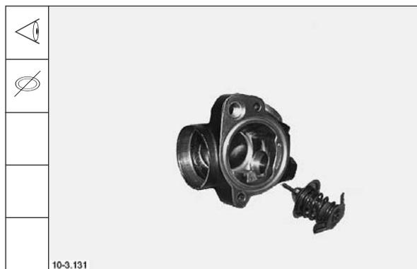
3. Thermostat niederdrücken und in Thermostatgehäuse hineindrehen.
