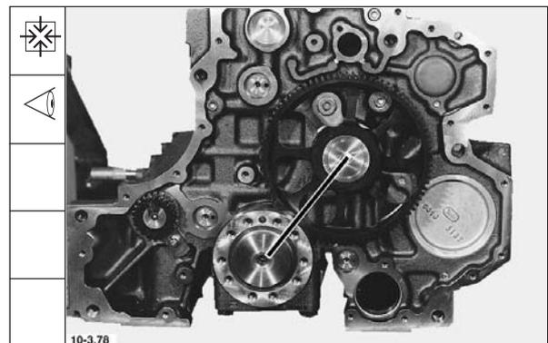
24. Zwischenrad einsetzen und leicht in den Eingriff des Zahnrades der Kurbelwelle drücken.
