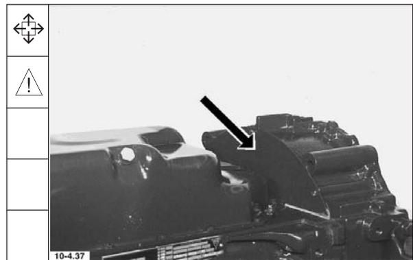
39. Motor um 90° drehen. Anschlußgehäuse abbauen.
