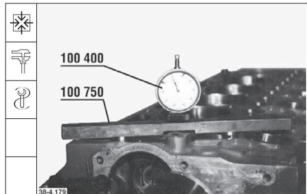
63. Kurbelwelle ca. 90° entgegen der Motordrehrichtung drehen. Danach wieder in Motordrehrichtung bis 8 mm vor O.T. (Umkehrpunkt der Meßuhr) drehen. Gradscheibe auf "0" stellen.
