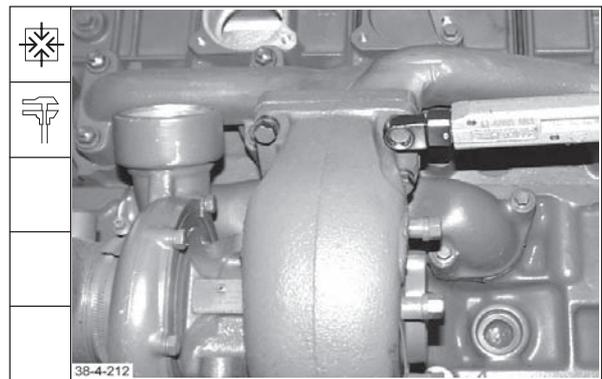
**Ölrücklaufrohr/Druckölleitung BFM 1012**
