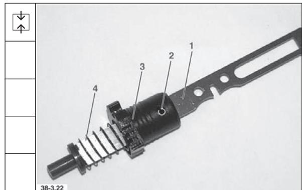
4. Einbaurichtung der Regelstange zur Führungsbuchse beachten.
