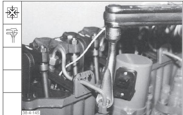
119. Leckölleitung anbauen und durch Dichtungsmis einführen.
