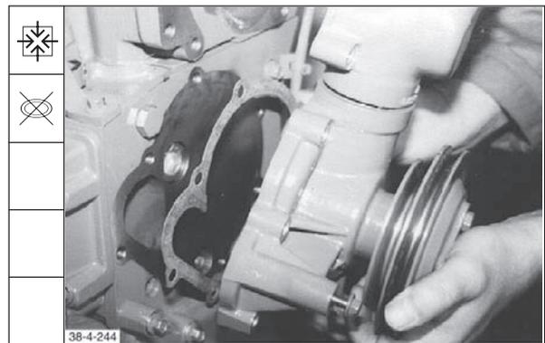
137. Schrauben wechselseitig mit einem Drehmoment von **21 ± 2 Nm** festdrehen.
