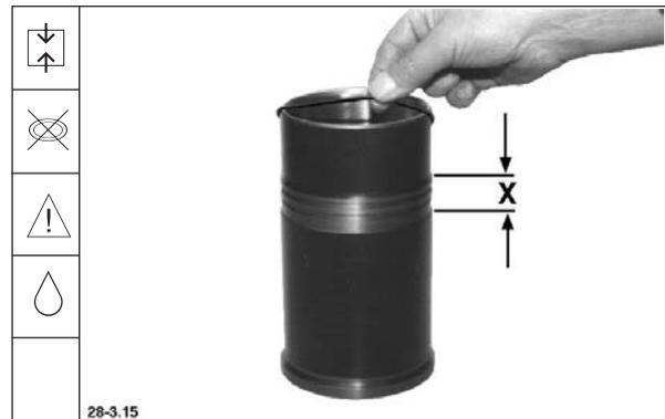
36. Zylinderlaufbuchse bis Anlage eindrücken.
