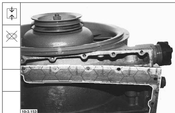
19. Deckel anbauen. Schrauben mit einem Drehmoment von **9 Nm** festdrehen.
