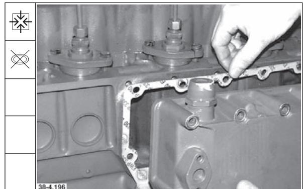
128. Schrauben mit einem Drehmoment von  $21 \pm 2 \text{ Nm}$  festdrehen.
