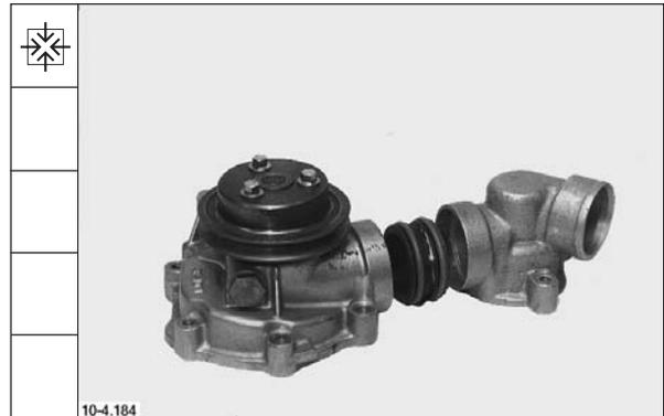
135. Neuen Runddichtring in Thermostatgehäuse einsetzen.
