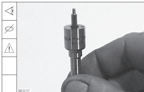
**Hinweis:** Bei ruckweisem Abgleiten der Düsennadel die Einspritzdüse erneut in Dieselkraftstoff auswaschen, bei Bedarf erneuern. Neue Einspritzdüse ebenfalls in sauberem Dieselkraftstoff reinigen.
